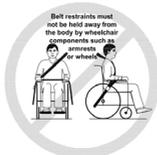
Toujours utiliser les ceintures de retenue pour occupant de la voiture pour l'utilisateur du fauteuil roulant. Les harnais d'ajustement utilisés dans un fauteuil roulant ne sont pas des ceintures de sécurité. Utilisez toujours les ceintures pelviennes et d'épaule pour réduire les risques de blessures à la tête et aux épaules.
