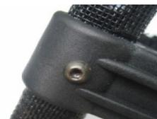
2. Entfernen Sie die 4 Schrauben des Kopfstützenadapters
