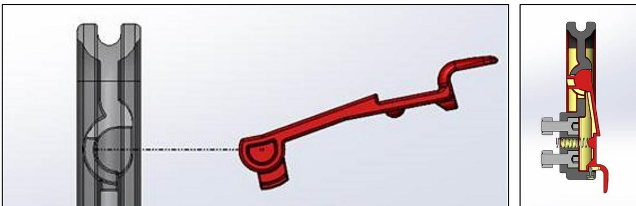
Heben Sie den Hebel nun soweit an, dass Sie die Feder in das mittlere Loch der Armlehnen-Halterung einsetzen können. Bewegen Sie den Hebel dann wieder nach unten und achten Sie darauf, dass die an der Rückseite des Hebels befindliche Erhebung die Feder in der Position hält.
