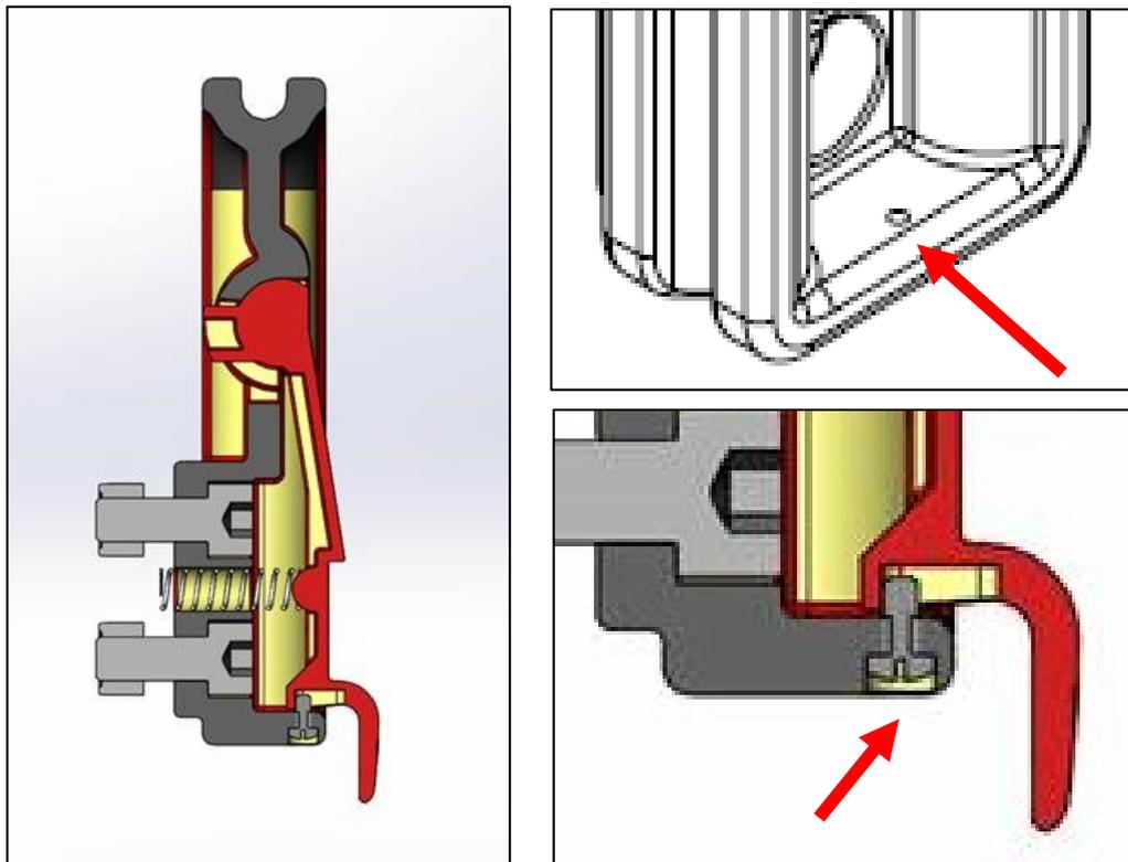
Im Hebel befindet sich ein Langloch, welches eine Bewegung des Hebels erlaubt um die Armlehne automatisch nach dem Einsetzen zu verriegeln.
