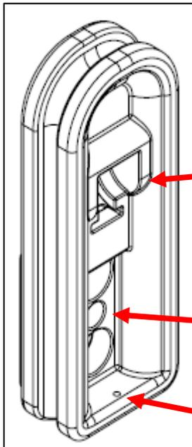
Hier wird der obere Teil des Verriegelungshebels eingehängt.
