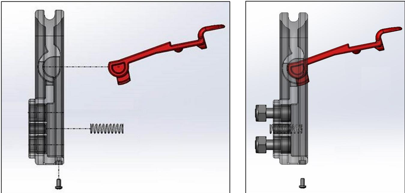
Beginnen Sie die Montage, indem Sie den Verriegelungshebel horizontal an die Armlehnen-Halterung heran führen und ihn in die in der Halterung dafür vorgesehene Aussparung schieben. Dann klappen Sie den Hebel nach unten.
