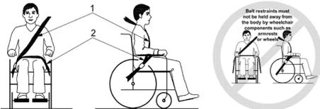
Verwenden Sie für den Benutzer des Rollstuhls immer die Rückhaltegurte des Autos. Das bei einem Rollstuhl zur Haltungskorrektur verwendete Geschirr kann Sicherheitsgurte nicht ersetzen. Verwenden Sie sowohl Becken- als auch Schultergurte, um die Möglichkeit eines Aufpralls von Kopf und Brust auf Fahrzeugteile zu verringern.
