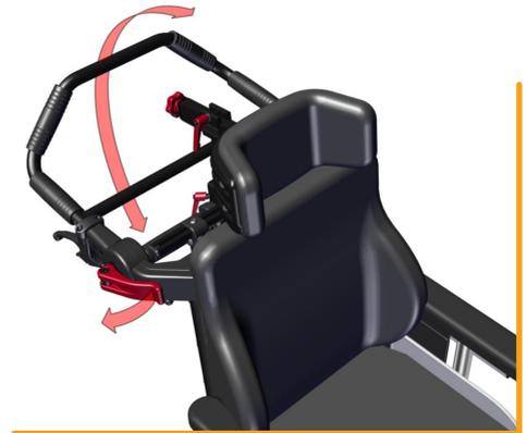
**⚠️** Stellen Sie sicher, dass die Drähte zu den Bremsen und den Kantelungs-/ Neigungsfunktionen niemals scharf geknickt werden.
