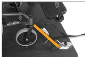
**À l'avant :** Utiliser une attache à crochet ou à sangle.
