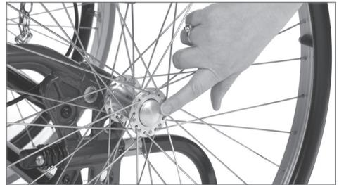
Les roues principales de 12" et 16" avec frein à tambour sont installées par le revendeur.
