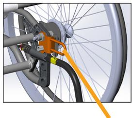
L'angle des sangles doit être d'environ 45°
